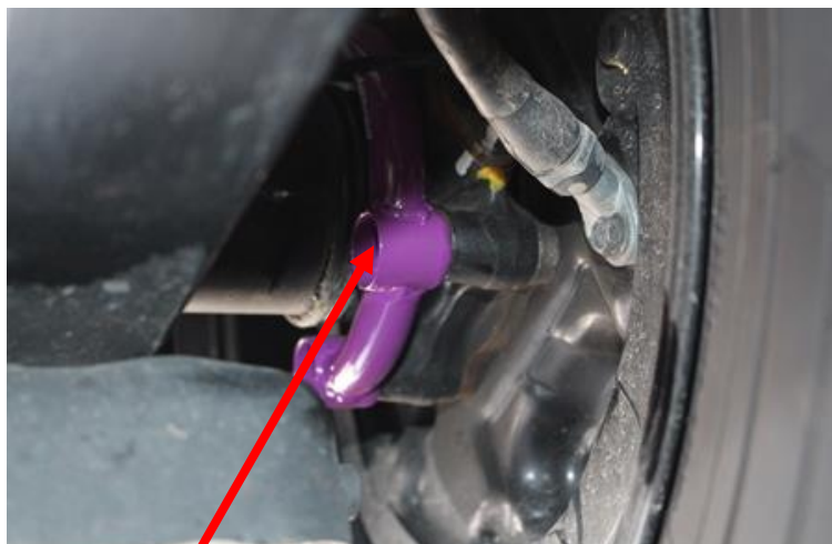
リアドラム取付けボルトをと共締め 3箇所
