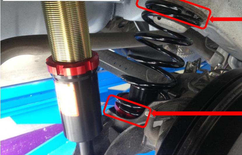
スプリングを純正ラバーに密着させ隙間が出来ないようにジャッキでアクスルを持ち上げる。(プリロードさせる)
