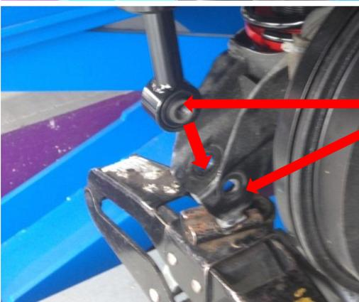
ショックの長さを調整してアクスルのボルト穴に合わせます。
