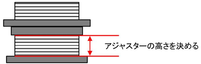
高さを決めたら車両に取付けしスプリングを乗せる
