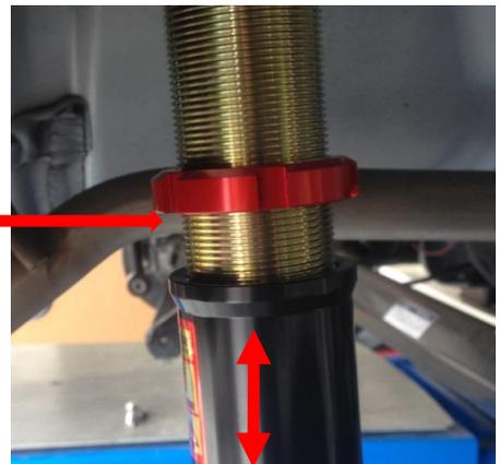
エンドブラケットのボルトナットを締め付け後ジャッキを下げ、スプリングやアジャスターの遊びが無いか確認して下さい。
